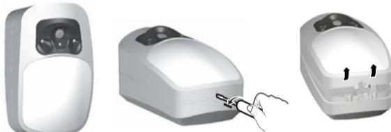
**FR** Tracez et percez les trous en fonction de l'emplacement du détecteur (voir ci-contre A, B, C ou D), puis fixez au mur.
