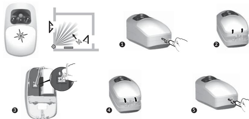
**FR** Le voyant clignote à chaque détection, la pile est usée (< 2,7V). Le DMBV TYXAL+ utilise un bloc-pile spécifique DELTA DORE. Contactez votre installateur. Si une centrale d'alarme est associée, passez-la en mode maintenance avant d'ouvrir le produit (voir notice d'installation système).
