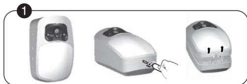
**FR** Tracez et percez les trous en fonction de l'emplacement du détecteur (voir ci-contre A, B, C ou D), puis fixez au mur.
