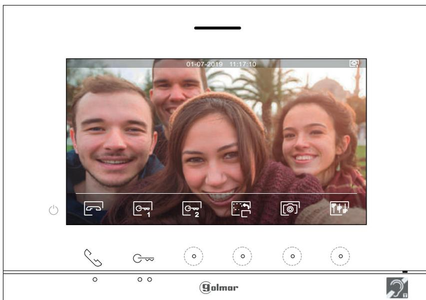
Cet écran s'affiche pendant le processus de communication. La date et l'heure sont affichées en haut au centre de l'écran, et la source d'origine d'où provient l'image est indiquée sur le côté droit platine 1, platine 2, caméra 1 ou caméra 2).
