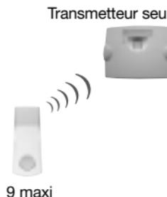
**3<sup>e</sup> configuration :** peut se cumuler aux 2 premières et permet à la commande d'alerte d'urgence de piloter, à l'aide du bouton-poussoir, des appareils électriques ou un éclairage par l'intermédiaire de récepteurs de commande ou de prises télécommandées.
