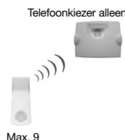
**3<sup>e</sup> configuratie:** kan aan de twee configuraties gekoppeld worden waardoor de alarmzender, via de drukknop, elektrische toestellen of een verlichting kan besturen met behulp van besturingsontvangers of stopcontacten met afstandsbediening.
