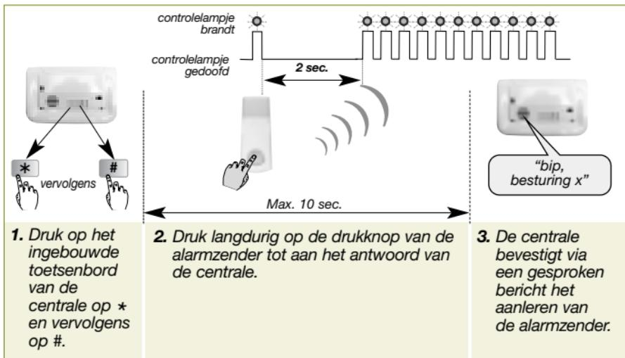
**OPGELET:** de centrale signaleert een manipulatiefout via 3 korte bips. Herneem in dat geval de aanleringsprocedure van bij het begin.
