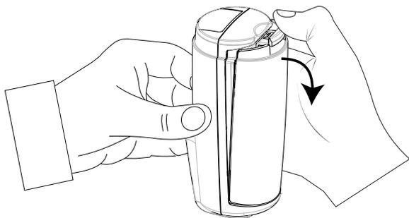
Figure 14 : Ouverture du capot des piles
