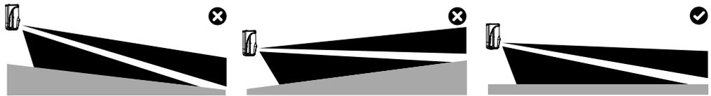
Figure 3 : Installation sur sol plat
