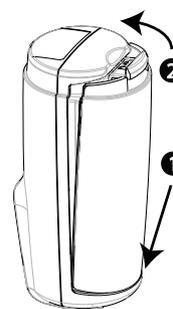
Figure 17 : Fermeture du capot des piles
