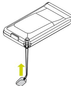
**02** Ouvrir le boîtier en actionnant l'ergot de verrouillage situé à l'extrémité de la télécommande.
