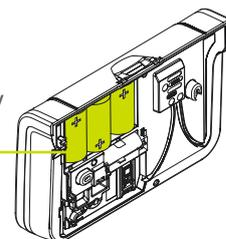
**02** 10 s environ après la mise en place de la 3<sup>e</sup> pile, la centrale confirme le branchement correct par le message vocal :
