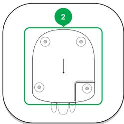
2 - Plaque de montage de SmartBracket (glissez de force vers le bas pour ouvrir ; une section perforée est nécessaire pour déclencher l'invulnérabilité lors des tentatives d'arrachement du hub de la surface)
