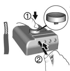
A l'aide de l'outil fourni ou d'un tournevis de 2,5 mm, appuyez sur le bouton de la borne puis insérez le fil.
