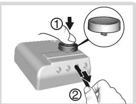
**!** Ne pas dénuder les fils lorsqu'ils sont connectés sur le produit au risque d'endommager le connecteur interne.
